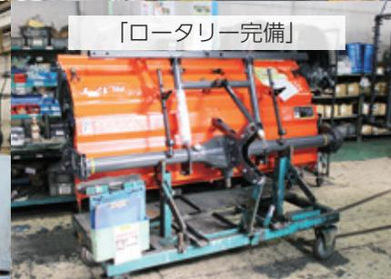
トラクタが大型化すると、それに装着するロータリー等の部品も大型になっていきます。以前は1,400~1,500mm幅のロータリーが主流でしたが、現在は、2,400mm、以前の倍の幅が主流になりつつあります。そのような動きに合わせて、当社では、生産設備を更新させながら対応しています。
