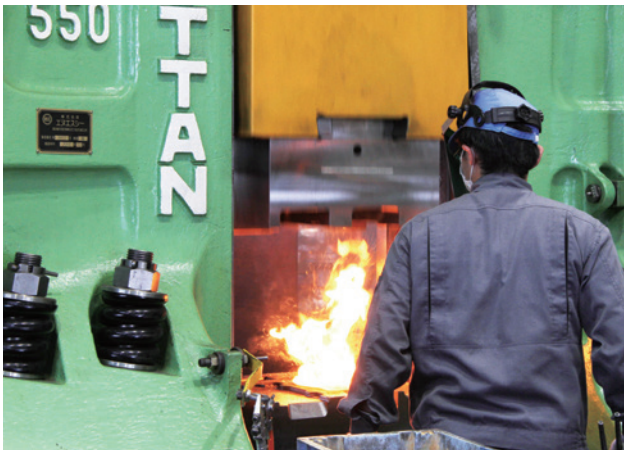
鉄素材の鍛造作業の様子
