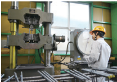
溶接部分の強度を確認する様子
