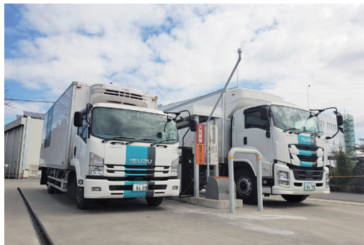
自家用給油設備と冷凍冷蔵車
