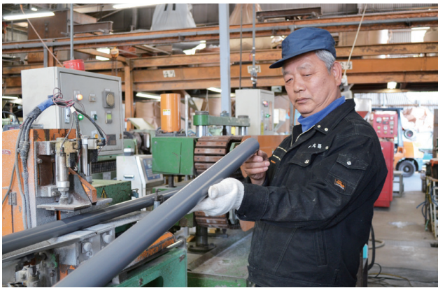
塩ビ再生パイプの仕上がりを確認する熟練職人
