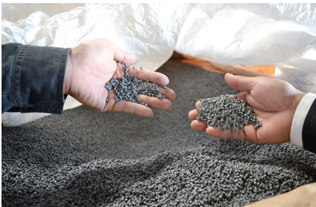
塩ビ再生パイプの原料となるプラスチック再生原料は、グループ企業の(株)照和樹脂から仕入れている
