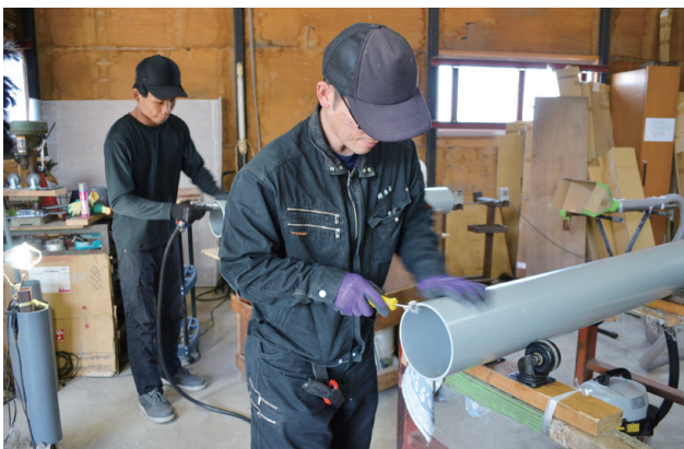
パイプの端を加工している若手職人(手前) パイプ内の塵を取り除いている若手職人(奥)
