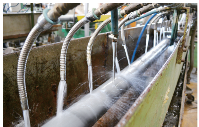
押出機で成形された塩ビ再生パイプを冷却する様子 現在、押出機は15台稼働中
