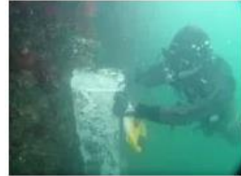
陽極消耗量調査
