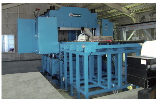
【2,000 t プレス】有効面積 3,000 mm × 2,000 mm 様々な形状のゴム製品に対応可能です。
