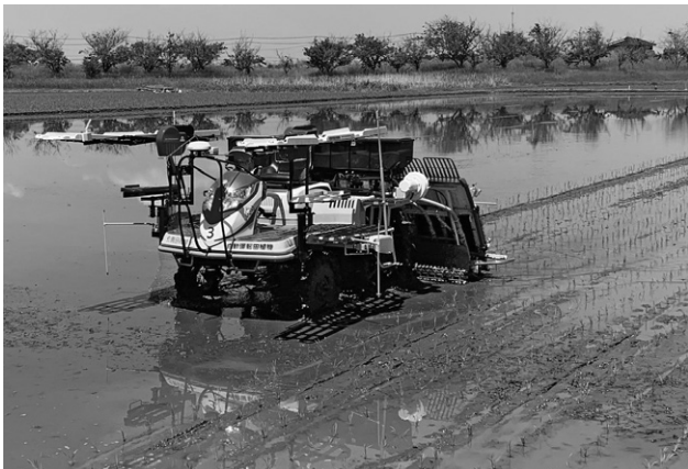
YAMAGUCHI farm株式会社で行われた自動運転田植え機による田植えの様子（茨城県県南農林事務所より提供）
