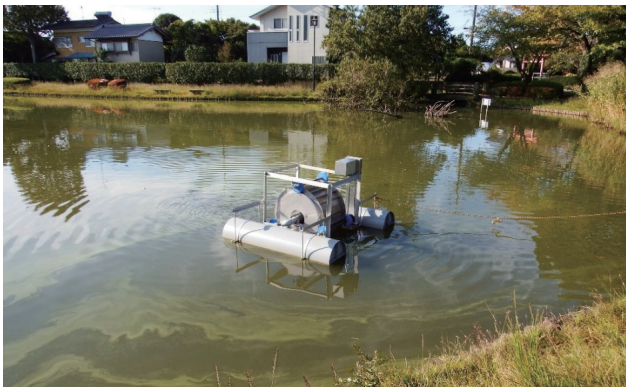
アオコ処理運転後の様子(10日目AM8時半頃) アオコが集積したマット状帯が除去され、悪臭も無い (写真提供：(有)アルファサービス)
