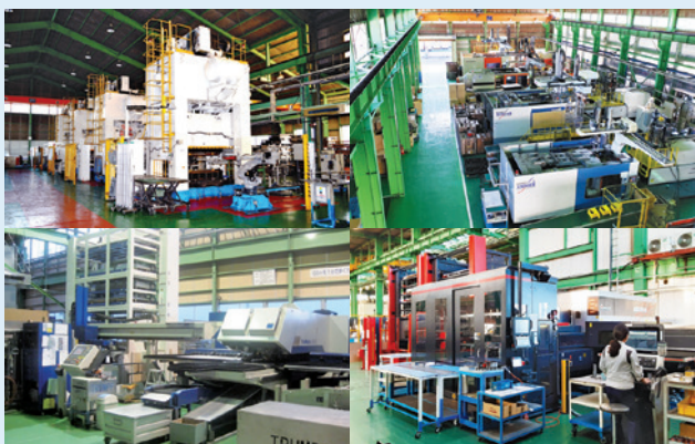
左上：新城工場（400t大型ロボットライン（9連）） 左下：上野原工場（パンチ・レーザ複合加工機） 右上：小山工場（大型成型工場） 右下：玉戸工場（パンチ・ファイバーレーザ複合加工機）
