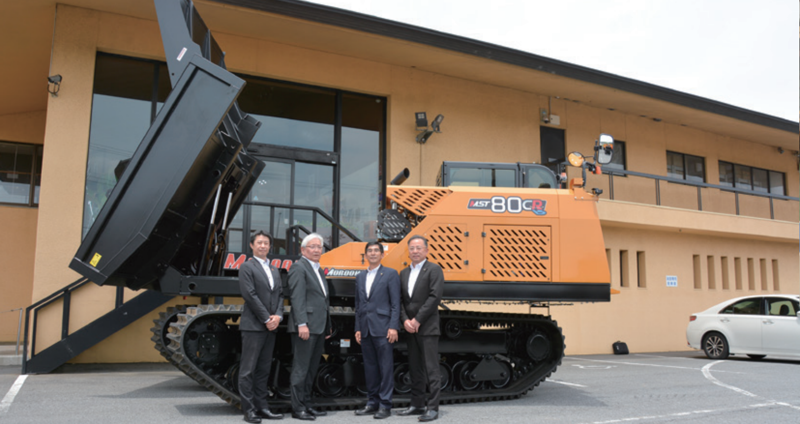
ゴムクローラと油圧式HSTシステムを採用したキャリアダンプ(不整地運搬車)
