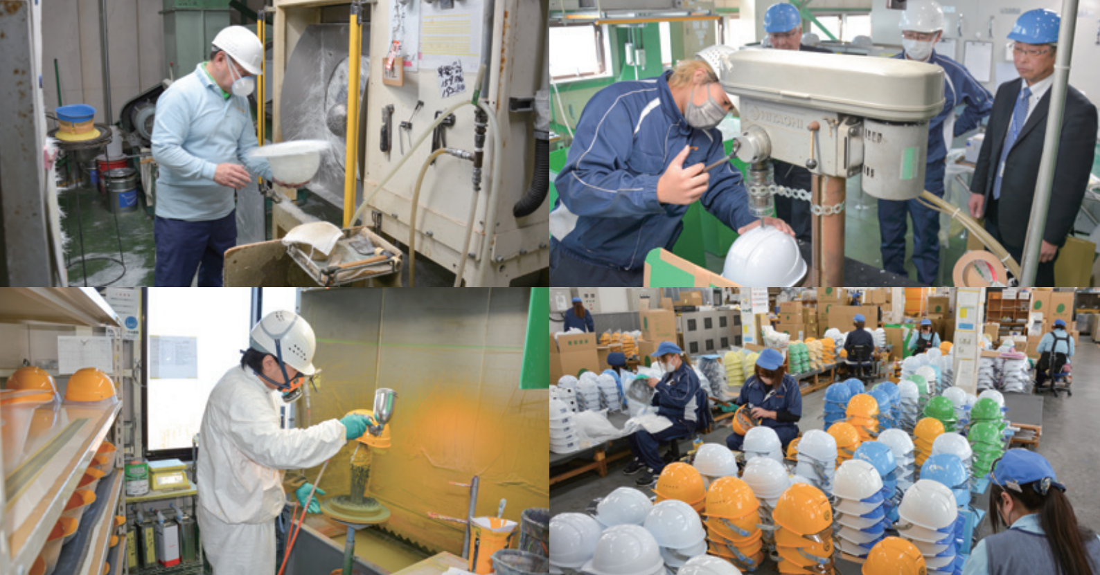
(左上) 産業用ヘルメットのプリフォーム作業、(右上) 穴あけ作業、(左下) 塗装作業、(右下) 名入れ作業
