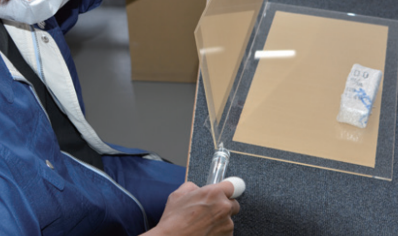
アクリル同士を接着する高度で繊細な手作業
