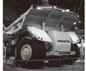
写真3 コマツの開発する自動運転トラック
