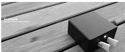
写真：モールス式キーボード Forethumb「フォーサム」 技術検証品
